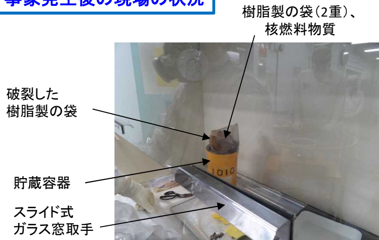
事象発生後の貯蔵容器 (6月6日 事象発生後に108室内の作業員により撮影)
